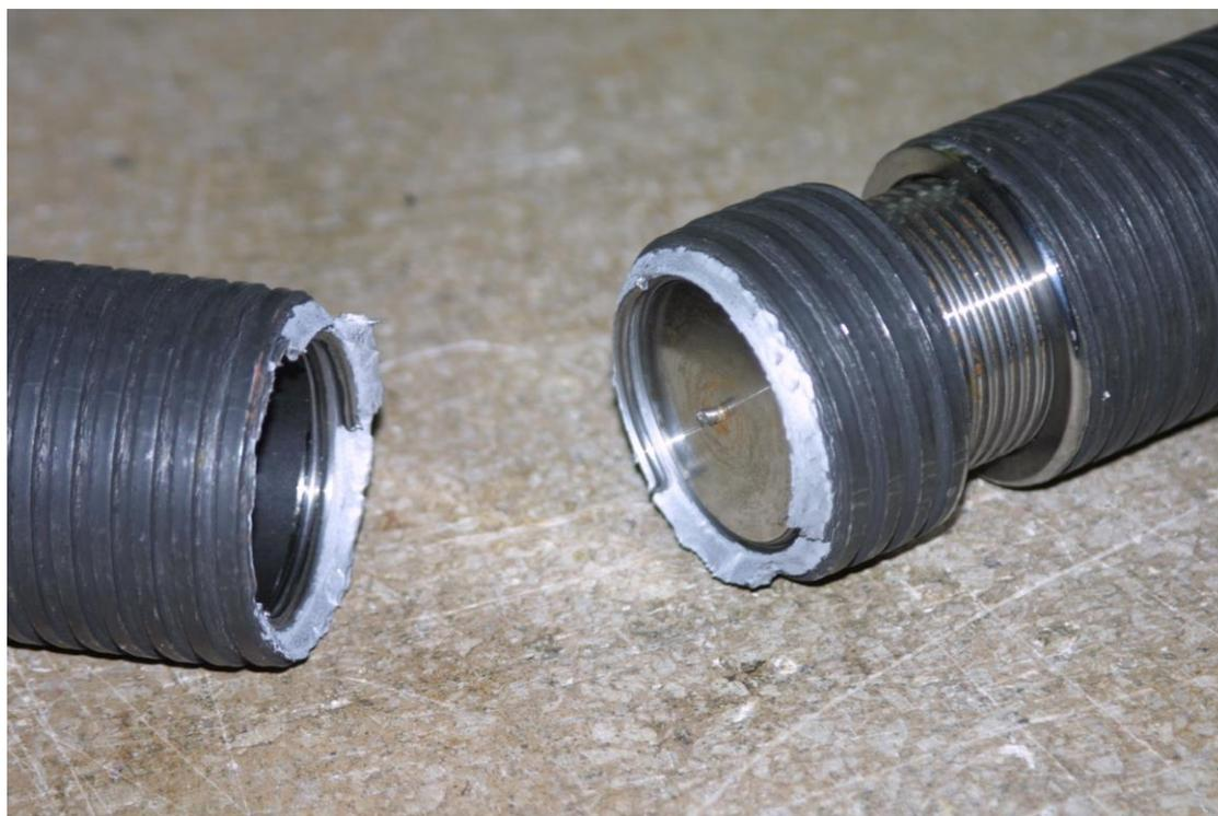
**Fractura tipo del pilote, en el inicio de la rosca de unión (Probeta 1)**
