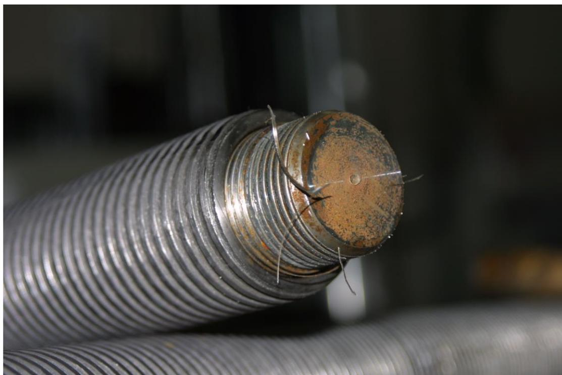
**Fractura tipo del roscado, por segado de hilos de rosca (Probetas 2 y 3)**
